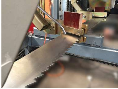
Movable band saw stabilizer and guider Hareketli şerit testere sabitleyici ve fiber ağızlık
