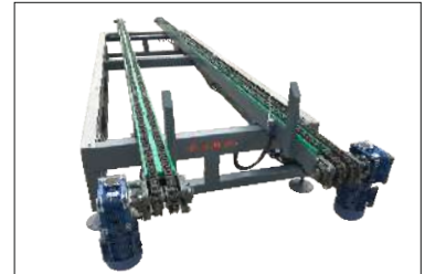
Unloading conveyor 4 - 8 m. length İstif boşaltma 4 - 8 metreye kadar
