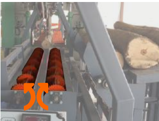
Log right-left turning Tomruk sağ-sol döndürme dişlileri
