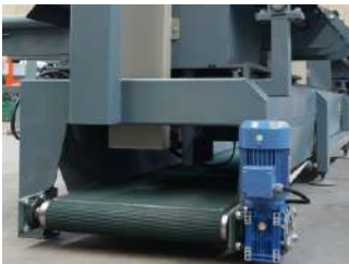
*Board conveyor band Kesilen parça taşıma bandı *(Optional Opsiyonel)
