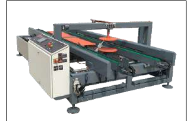
Turner 180° and rotator 90° 90° Döndürme ve 180° Takla atma
