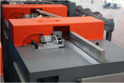
Pneumatic plate stabilizer for cutting Sabit kesim için pnömatik yan destek
