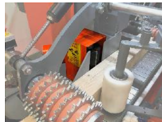
Edge milling and press rollers Malzeme kenarı sakal alma
