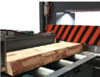
Upper press stabilizer for cutting Üst baskı kesim sabitleyicisi
