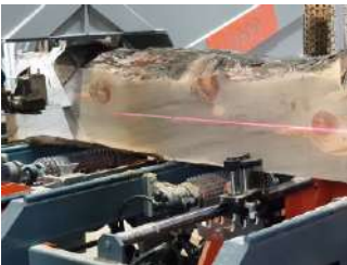
Laser sight for cutting line Kesim çizgisi için lazer
