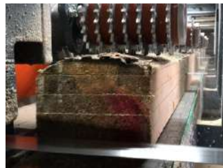
Cutting height max. 350mm Kesim yüksekliği max. 350mm
