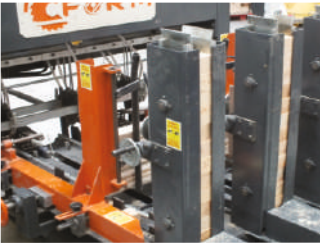
Block magazine for automatic feeding Takoz ölçüsüne göre ayarlanabilir şarjör
