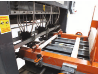
Board magazine for automatic feeding Tahta ebatlarına göre ayarlanabilir şarjör
