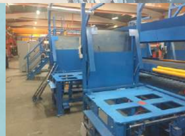
Pallet repair benches Palet tamir masaları
